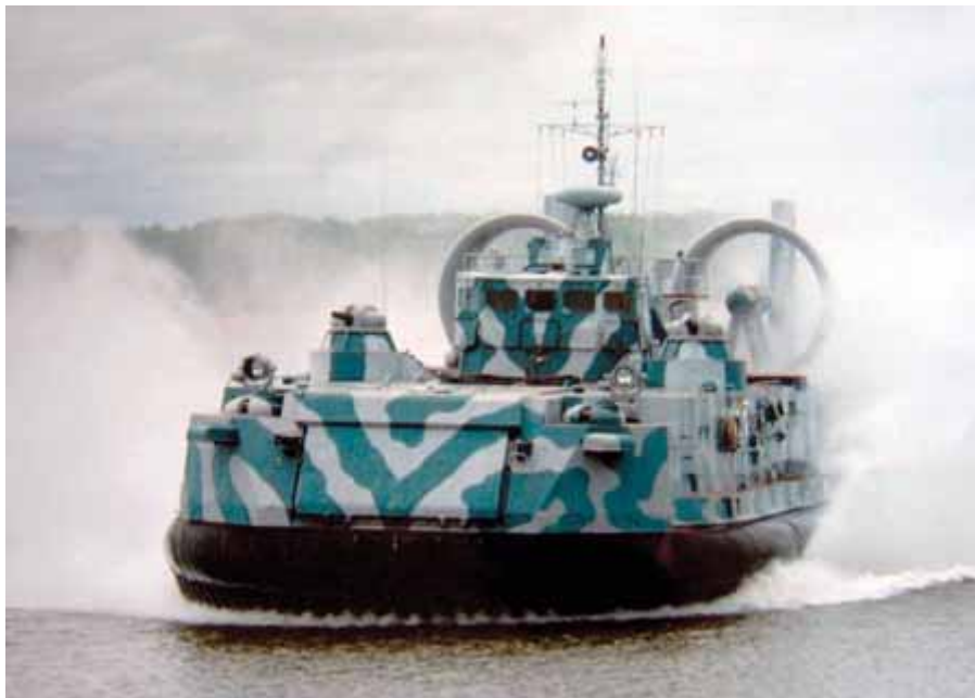
Рис. 1. Многоцелевой десантный корабль на воздушной подушке «Мурена»
