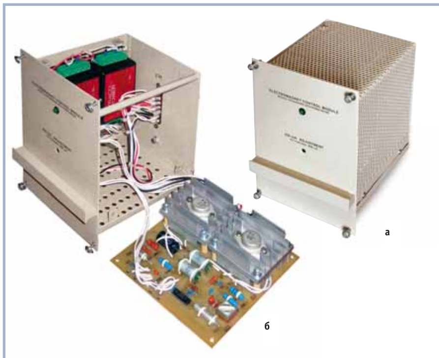
Рис. 3. Модуль управления электромагнитом (МУЭМ): а — внешний вид, б — со снятым кожухом и извлечённой электрической платой
